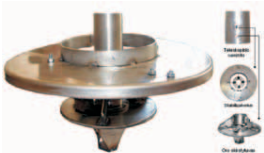
5 pav. patobulintas oro skirstytuvas su stabilizatoriumi
